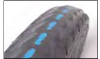
Der Pannenschutz scheint durch. Der Reifen muß dringend gewechselt werden.
