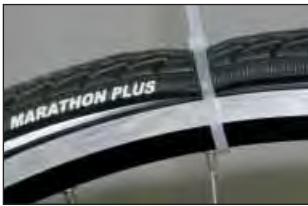
Ein Kabelbinder als helfende dritte Hand.
